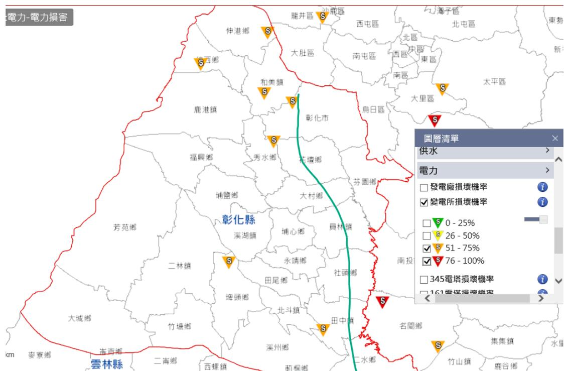
圖 1-3-8 模擬變電所損壞機率
